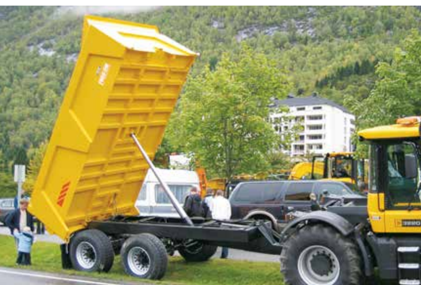
Solid kasse. Bunnplata ligger på kraftige tetsittende tverrbjelker. Bildet viser dumper med fjærer og utsyrt for full hastighet.
