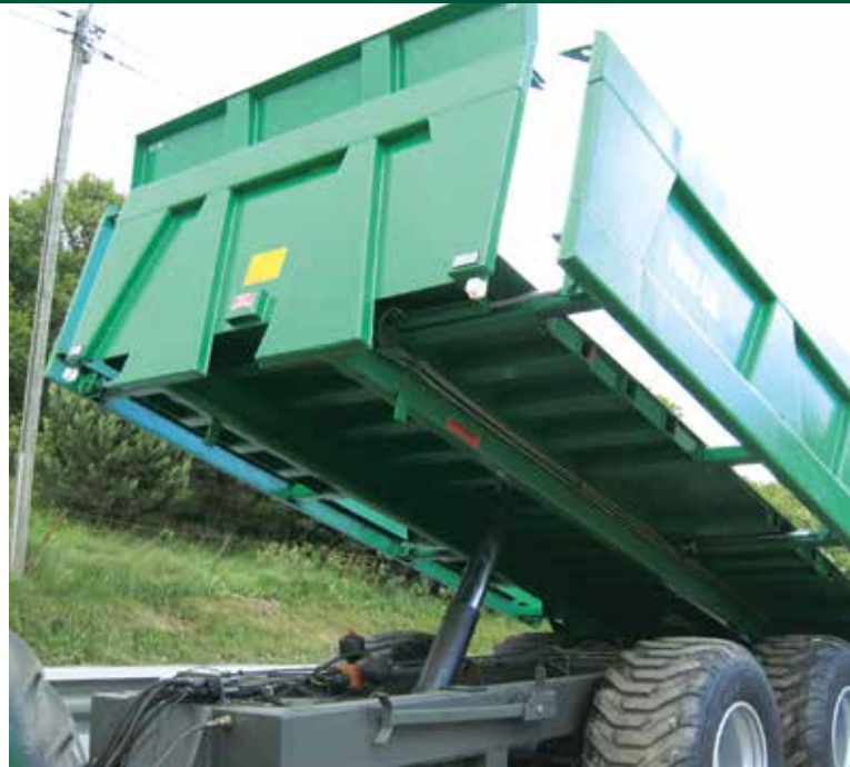
Utskyvbare sidelemmer gir ekstra bredde for transport av stor gravemaskin. Krever dispensasjon.
