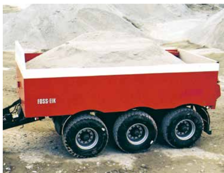
Trippelboggi 24 tonn. Last ca. 20 tonn. Kan leveres med sving på bakre og fremre aksel.
